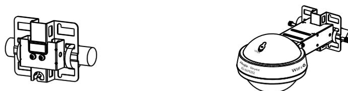
(1) Fije la placa de montaje en el soporte horizontal introduciendo dos abrazaderas para tubo a través de los orificios cuadrados de la placa de montaje. Apriete los tornillos con un destornillador Phillips.
