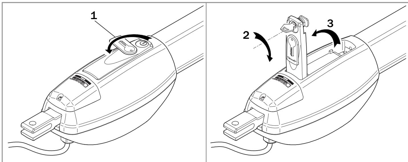
**FR** ATTENTION : effectuer les opérations de déblocage et blocage des vantaux en absence de tension de réseau et avec le moteur à l'arrêt.
