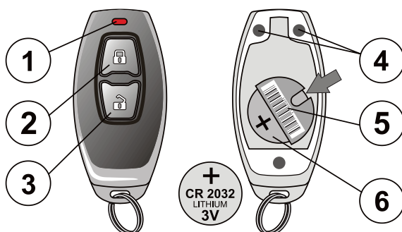
Slika: 1 – LED indikator; 2 – taster za uključenje (UK) alarma; 3 – taster za isključenje (ISK) alarma; 4 – zavrtnji na poleđini upravljača; 5 – serijski broj; 6 – CR2032 baterija (izvadite bateriju pritiskom u smeru strelice).
